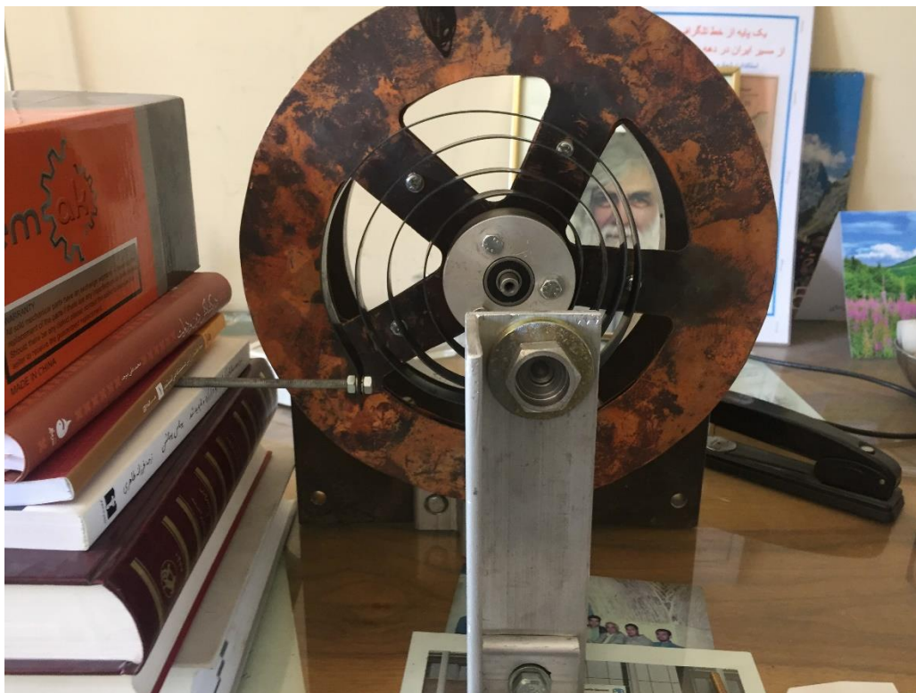
آموزش نوسان، تشدید، میرایی، تپش و حرکت کائوتیک با کمک چرخ پوهل (Pohl) در دانشگاه تهران برای مشاهده کلیک کنید اینجا
